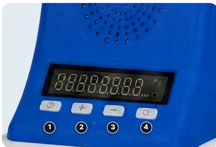
Parte de atrás del dispositivo: 1 Encendido · 2 Volumen + · 3 Volumen - · 4 Repetir
